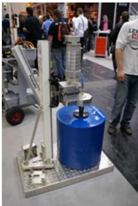
Till vänster: Pentruders högfrekventa bormotor.
