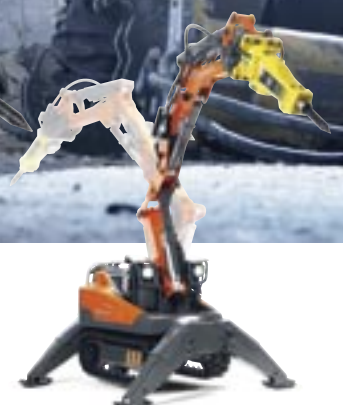
HUSQVARNA DXR 140 Fast arm med 360° svängradie, 15 kW/960 kg.
