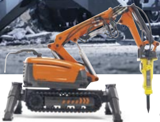
HUSQVARNA DXR 310 5,5 m räckvidd, teleskoparm, 22 kW/1 960 kg.
