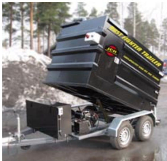
Dust Fighter Trailer med luftflöde på 1260m 3 /tim.
