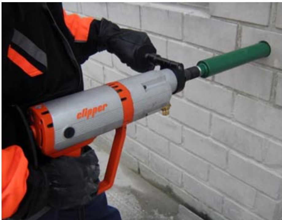
Handhållen kärnbormaskin från Clipper med motorhus av aluminium för lättare vikt.
