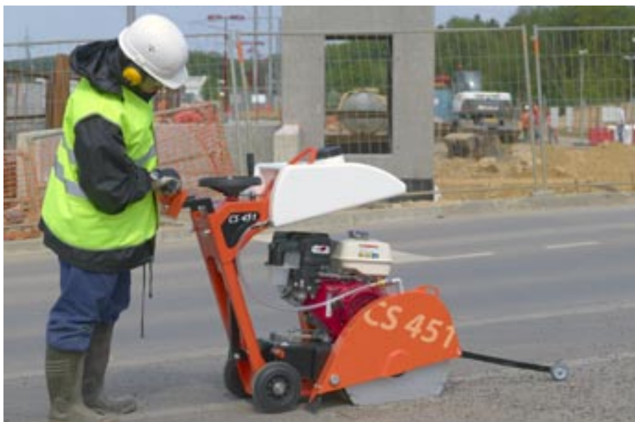
Vibrationsnivån har sänkts med 30% och minskar bl.a. risken för vita fingrar.
