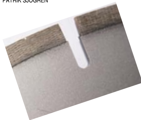
Sågklingan Edit med positionerade diamanter!
