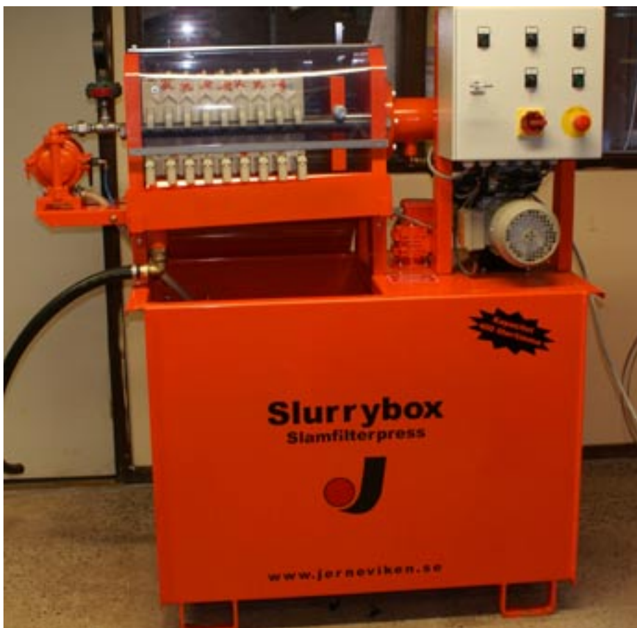
Slammfilterpressen som har kapacitet för upp till 400 liter slamm per timme!
