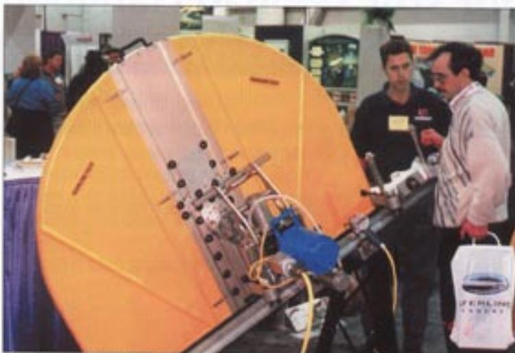
*Väggsåg med elektronisk drivenhet, liknande Hydrostess elväggsågsutrustning.*
